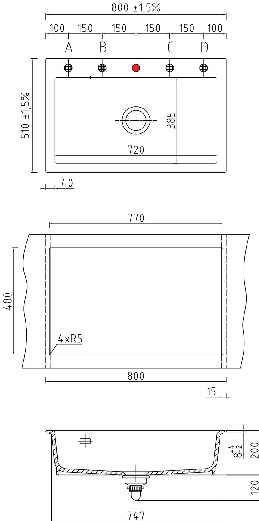
● Armaturbohrung vorhanden. Keine Sollbruchstellen.
